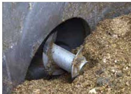
Zusatzschnecke für Rondomatknöten: Gewährleistet gesteigerte Durchsatzleistungen und einen kontinuierlichen, gleichmäßigen Materialfluss; erforderlich bei Substratlängen über 50 mm bzw. bei nicht rieselfähigem Material.
