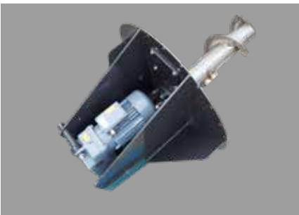
Zusatzschnecke für Rondomatknöten: Gewährleistet gesteigerte Durchsatzleistungen und einen kontinuierlichen, gleichmäßigen Materialfluss; erforderlich bei Substratlängen über 50 mm bzw. bei nicht rieselfähigem Material.
