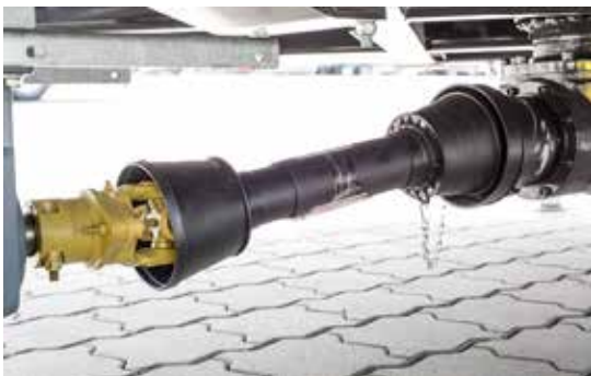
Zapfwellenantrieb mit Abscherschraube
