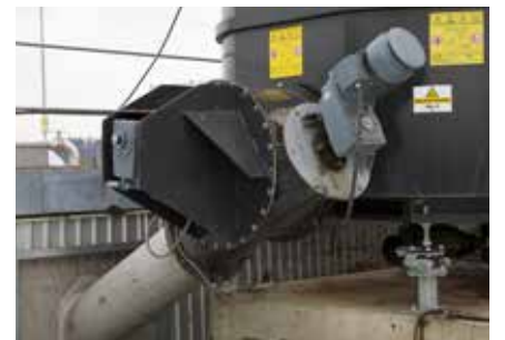
Zusatzschnecke für Rondomatknöten: Gewährleistet gesteigerte Durchsatzleistungen und einen kontinuierlichen, gleichmäßigen Materialfluss; erforderlich bei Substratlängen über 50 mm bzw. bei nicht rieselfähigem Material.
