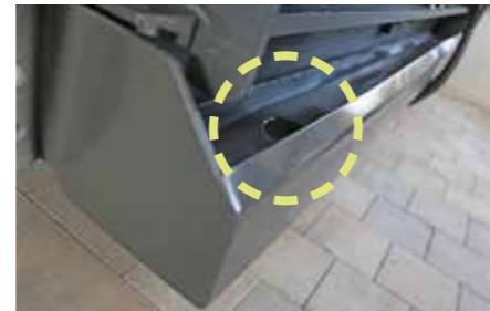
Sickersaftrinne mit Anschluss Ø 100 mm
