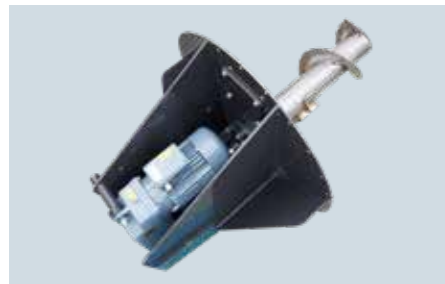
Zusatzschnecke für Rondomatknoten – erforderlich bei Substratlängen über 50 mm bzw. bei nicht rieselfähigem Material
