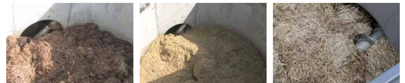
Das langsam drehende Austragsschwert benötigt einen nur sehr geringen Energiebedarf. Zusatzschnecke für Rondomatknoten
