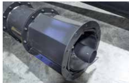
Schneckenförderrohr mit PE-Halbschalen
