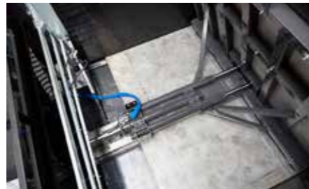
Abschiebesystem mit hydraulischem Zylinderpaket
