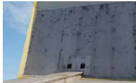
Schiebeboden und Schiebewand in V2A mit PU-Dichtleisten
