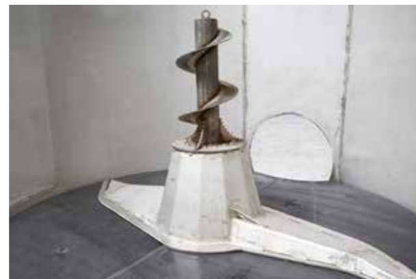
Optional: Edelstahlaustragsschwert mit Vertikalschnecke auf Polyethylenboden
