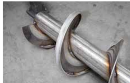
Schneckenwindung mit aufgeschweißtem Flachstahl
