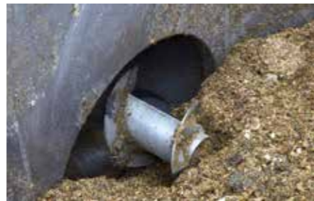
Zusatzschnecke für Rondomatknoten – erforderlich bei Substratlängen über 50 mm bzw. bei nicht rieselfähigem Material
