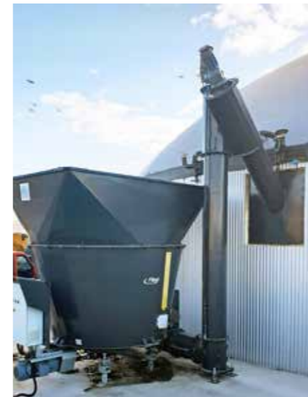
Störungsfreie Förderung des Substrates durch große Übergabeknoten
