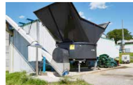
Offene Übergabe auf bestehendes Fördersystem
