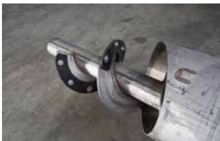
Vis d'insertion avec spire en PE
