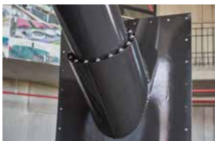
Bride de raccordement tube à tube avec joint pour anneau
