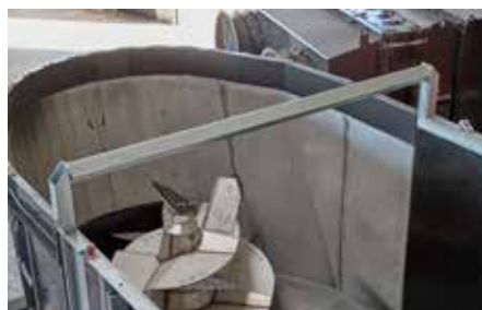
Renforts pour stabiliser les parois
