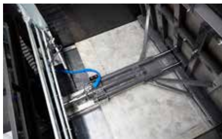
Système à fond poussant avec kit de vérins hydrauliques
