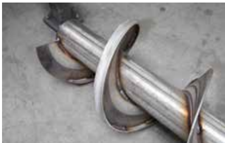
Spire de la vis avec acier plat soudé
