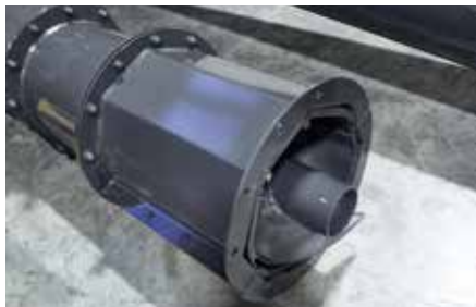
Tube transporteur de la vis avec demi-coques en PE
