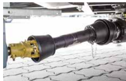
Entraînement par prise de force avec vis de cisaillement
