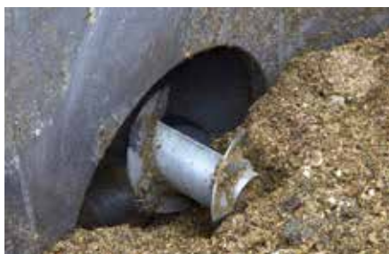
Vis supplémentaire pour nœud Rondomat – nécessaire pour des substrats de longueur supérieure à 50 mm ou pour les matériaux sans faculté d'écoulement
