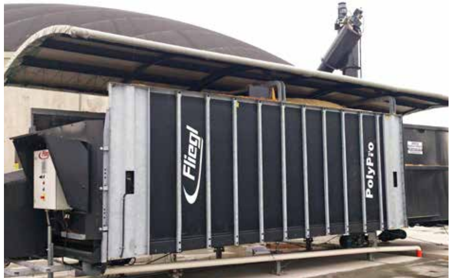
Structure de toit rabattable hydrauliquement
