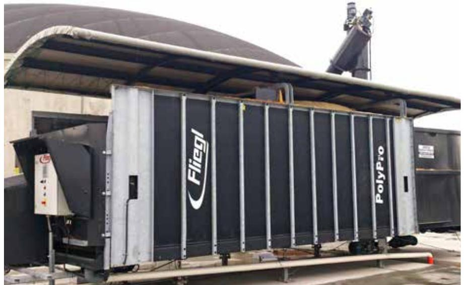
Struttura tetto ribaltabile idraulicamente
