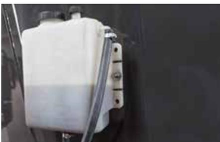
Serbatoio di compensazione olio per ingranaggi
