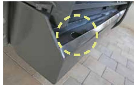
Canalina per liquame di percolamento con attacco Ø 100 mm
