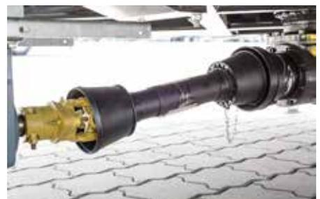
Azionamento presa di forza con vite di sicurezza
