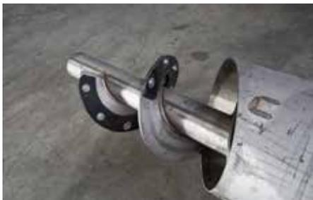
Coclea di alimentazione con spirale in PE
