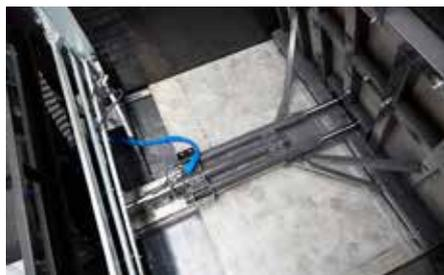
Sistema di spinta con pacchetto cilindri idraulico
