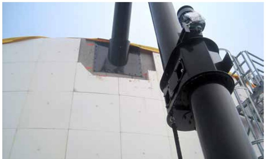
Coclea trasportatrice (tubo di rivestimento) di lunghezza superiore a 7.000 mm con intersezione di consegna.
